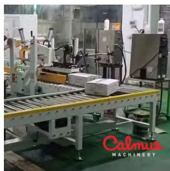
Автомат для вкладывания пакетов (также известный как машина для вставки вкладышей в коробки или установка для размещения вкладышей) подает пленку из рулона в коробка, разрезает и запаивает ее в мешок, раскрывает и отбортовывает мешок на клапанах коробки, затем подает воздух для расширения мешка, обеспечивая плотное прилегание к внутренним стенкам коробки.
