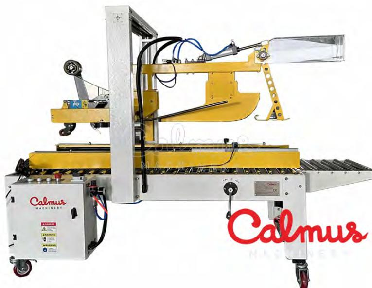
Данный запайщик коробок предназначен для герметизации верхней части гофрокоробов клеевой лентой после загрузки продукции.
