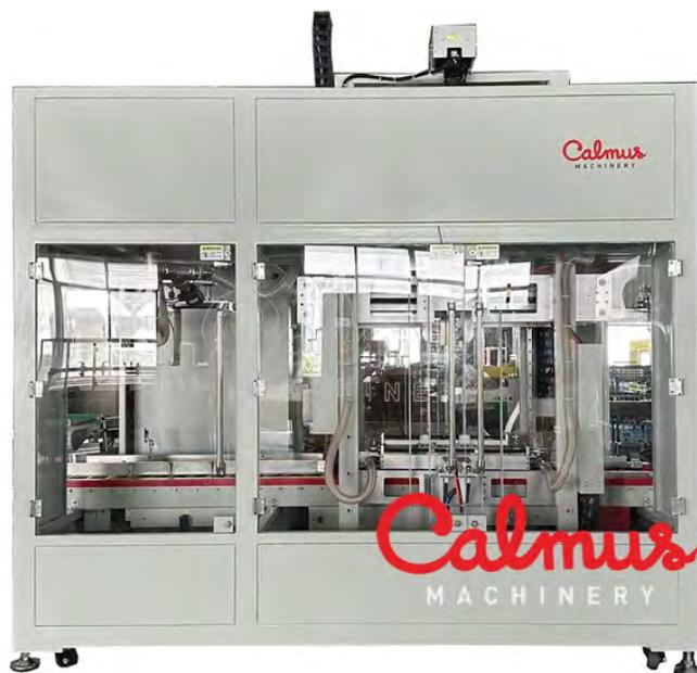
Данный автомат для снятия отбортовки и запайки полиэтиленовых мешков предназначен для термосварки мешков внутри коробок после их заполнения продуктом. Автомат снимает отбортовку мешка с верхних клапанов коробки, расправляет горловину мешка, создает слабый вакуум для предотвращения вздутия, запаивает мешок, а затем разглаживает его внутри коробки.
