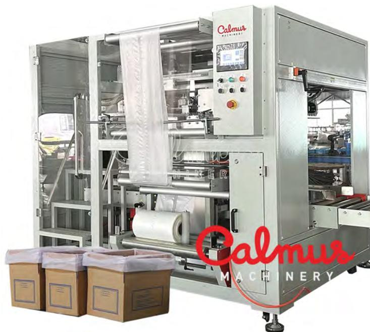
Данный автомат для вкладывания пакетов подает пленку из рулона в собранный коробка, разрезает и запаивает ее в мешок, раскрывает и отбортовывает мешок на клапанах коробки, затем подает воздух для расправления мешка, обеспечивая плотное прилегание к внутренним стенкам.
